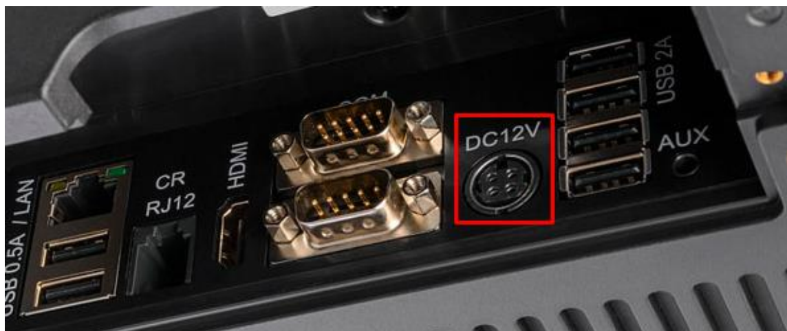
Разъём питания на АТОЛ Optima
